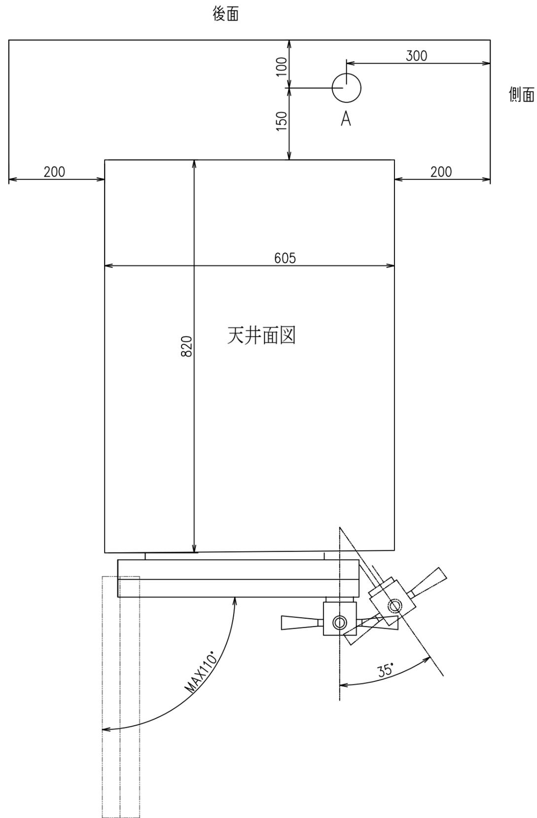
A.排水 鉄管 40A ソケット止め立上がりFL100mm
